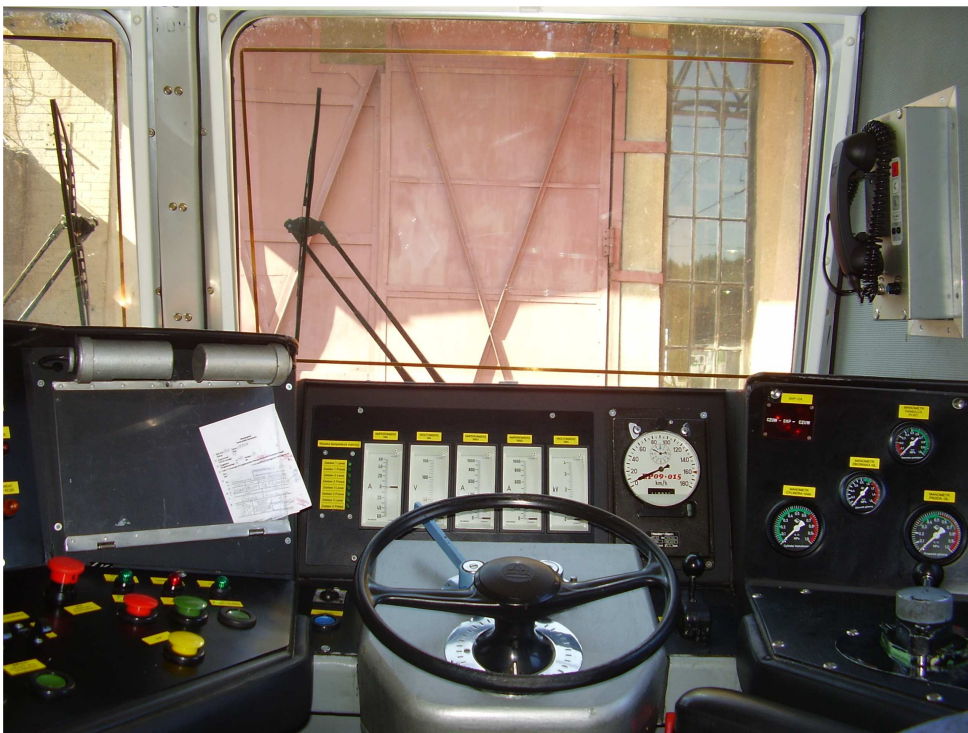
Rys. 1.7 Zmodernizowany pulpit sterowniczy lokomotywy EP09-015
