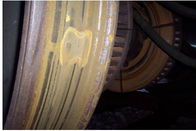
Rys. 2.4 Płaskie miejsca na powierzchni toczonej zestawu kołowego
