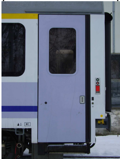
Rys. 2.20 Drzwi odskokowo - przesuwne systemu BODE
