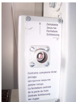
Rys. 2.23 Urządzenie do uruchomienia centralnego zamykania drzwi wejściowych pociągu
