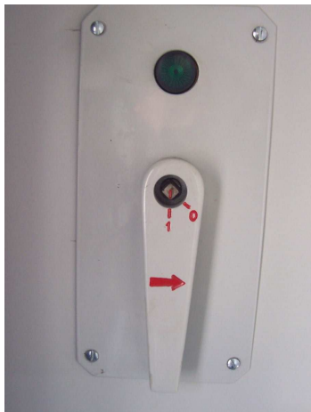
Rys. 2.22 Urządzenie do wyłączenia blokady drzwi 1 - jazda pociągowa (blokada włączona) 0 - jazda manewrowa (blokada wyłączona)
