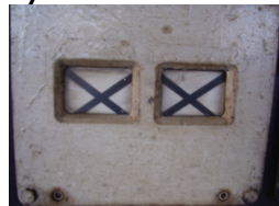
Rys. 3.15 Wskazania wziernika hamulca tarczowego
