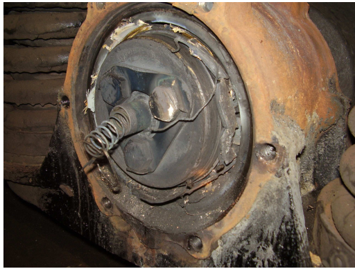
Rys. 2.6 Przykład zagrzanego czopa osi
