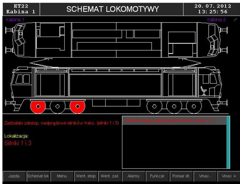
Rysunek 30 Stan wyłączników nadmiarowych silników
